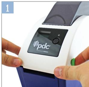
Um den Deckel des Druckergehäuses zu öffnen, müssen Sie nur die seitlich angebrachten Klappen in Richtung der Druckerfront schieben.
