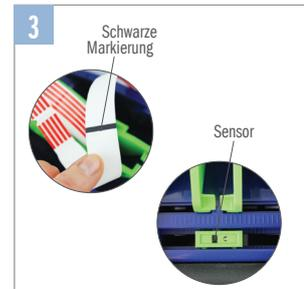
Damit der Sensor die Markierung erkennt, muss das Armband mit der schwarzen Markierung nach unten eingelegt werden.
