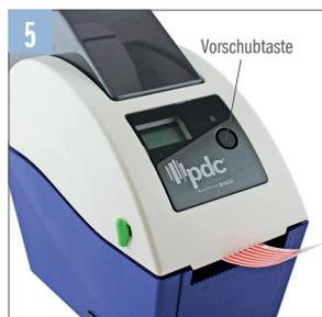
Nach jedem Wechsel der Armbandrolle müssen Sie einmal die Vorschubtaste drücken, bis das Ende der Rolle aus dem Drucker herauskommt und das grüne Licht aufleuchtet.
