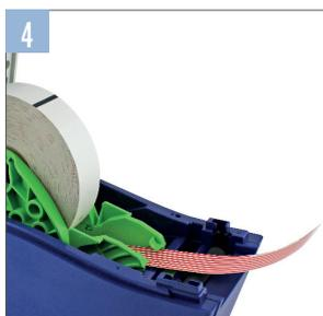
Korrekte Position des Armbands: Druckseite nach oben, Armband zwischen den Bandführungen hindurchführen.
