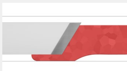
Zum Vergleich: Versiegelungsinstrument mit abgeschrägter Klingengeometrie.
