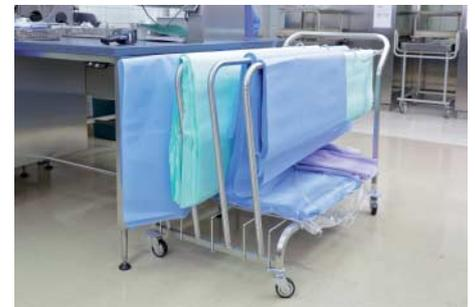
Abbildung 7: Variante zur hängenden Lagerung von Weichverpackung
