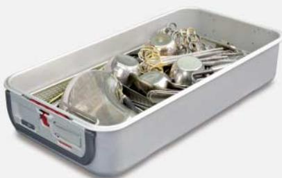
Grundsätzlich gilt, dass die Container bis maximal 5 mm unterhalb des Wannенrandes beladen werden dürfen. Ein zusätzliches Auflegen von Tüchern o. ä. ist nicht erlaubt. Dies führt zu erheblichen Trocknungsschwierigkeiten sowie evtl. Deformationen der Containerwannen.
