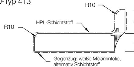
Vorderkante „Vollrundkante“ mit aufgesetzter Wischleiste
