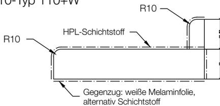
Vorderkante „Standard“ mit angeformter Wischleiste
