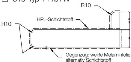
Vorderkante „Vollrundkante“ mit angeformter Wischleiste
